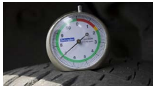
Pnevmatike: Globina kanala \geq 5 mm (USTREZNO) Opomba: Za določitev obrabe pnevmatik se izmeri globina najbolj obrabljenega kanala.
