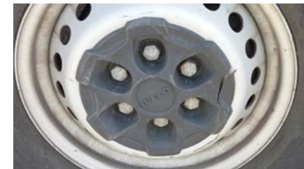
Pokrovi koles: deformirani, zlomljeni, manjkajoč ali odstranjen material
