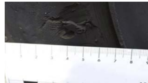
Pnevmatike: Zareza, globoka > 3 mm, manjkajoč material
