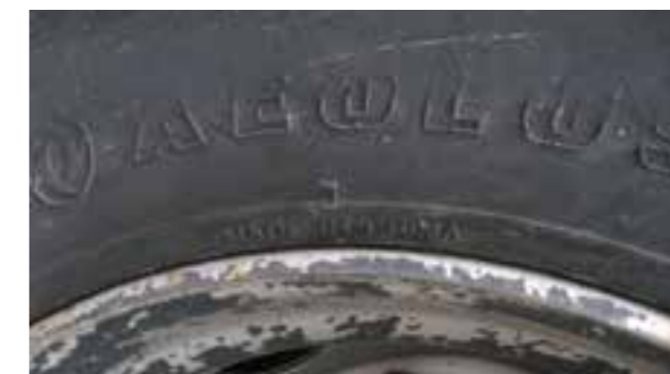
Pnevmatike: Globina kanala < 7 mm Opomba: Za določitev obrabe pnevmatik se izmeri globina najbolj obrabljenega kanala.
