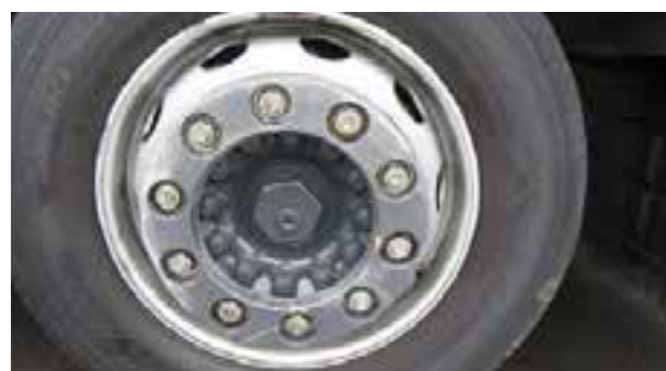
Platišča in pokrovi koles: več površinskih prask, pri čemer lahko manjka del materiala
